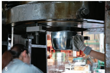
6・7 昭和43年、日本に初めて導入されたドローイングプレス機。板の直径よりも深く絞ることができる。総能力は180t、最大絞り深は530mm。低速で回転させながらゆっくりと加圧することで、均一した板厚を保ったまま成形ができる。8 プレスするごとに金型と加工する板を拭き上げる。9 大阪の工作機械メーカー・OKK(大阪機工株式会社)が製造したプレス機で、取り付けられたプレートには正式な型番(DRM-180)、製造日(昭和43年5月)、製品番号が記載されていた。もう1台は、同じOKKが製造した最大加圧400tのサイドフレーム型油圧プレス機。10 場内に積み上げられた金型。
